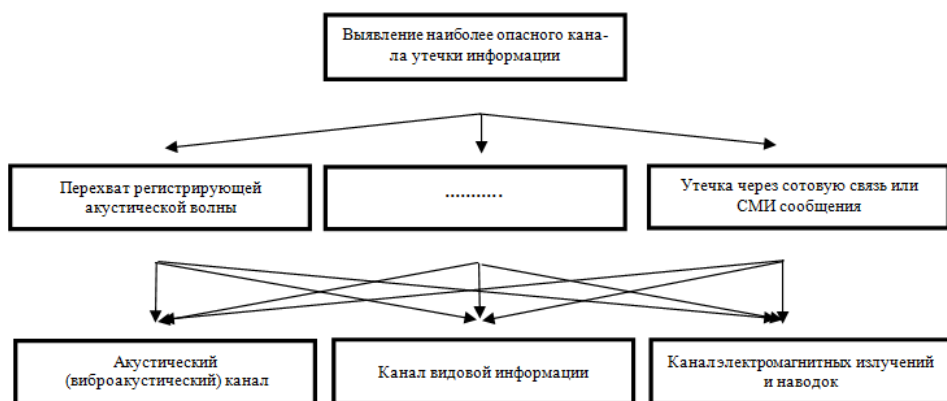
Рис. 1. Иерархическая структура проблемы выявления наиболее опасного технического канала утечки информации
